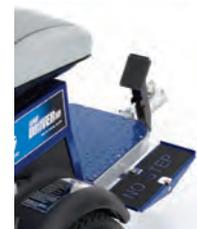
*Sistema de pedal doble patentado para ir hacia adelante y en reversa. ¡Alterne los trabajos sin tener que EMPUJAR la unidad!*
