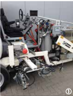
Procedimiento de dosificación: Bomba de fuelle para termoplásticos pulverizables con MALCON4E
