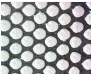
Cilindro giratorio en sentido contrario a la marcha ⇒ patrón con forma redonda.
