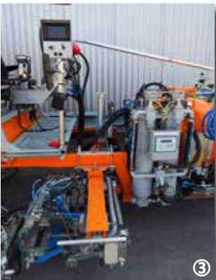
Procedimiento de dosificación: Bomba de fuelle para el componente de base de 98% y bomba de émbolo para componente endurecedor de 2%, para pinturas plásticas en frío 2c con MALCON4E
