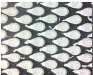
Cilindro giratorio en sentido de la marcha ⇒ patrón con forma de gota.
